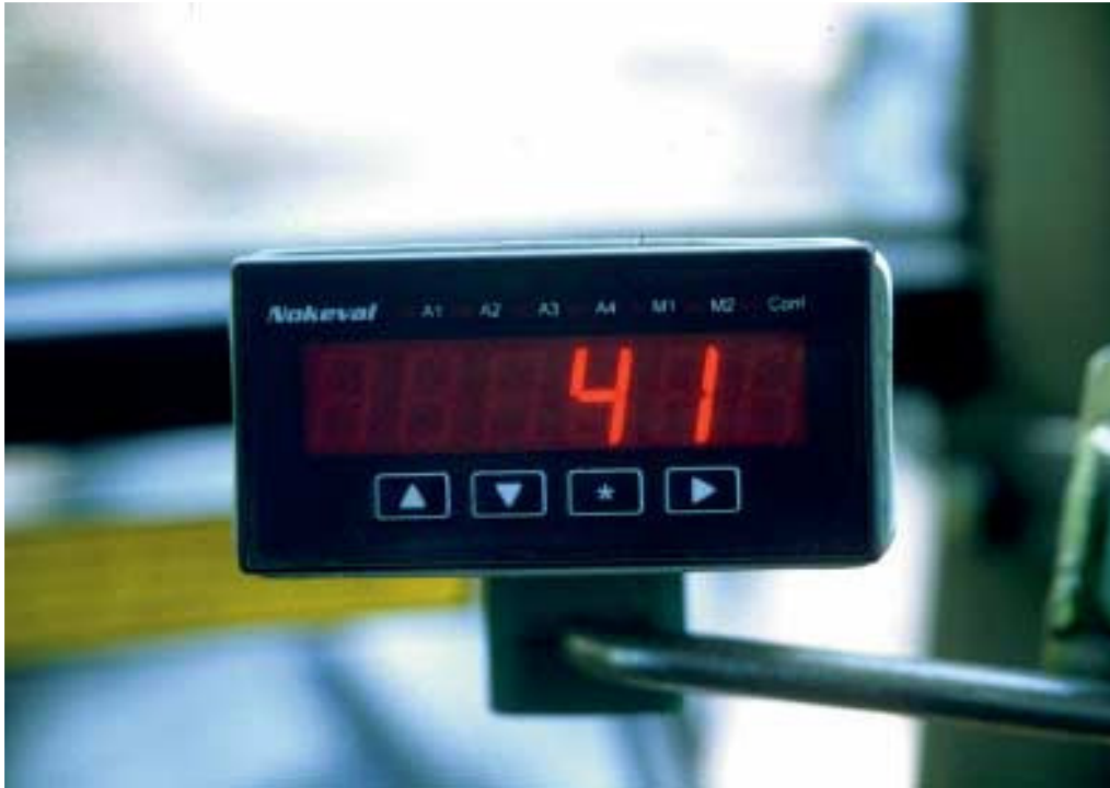
▲ Kylvösyvyys 41 mm, kaikki hyvin. Aivan millimetripeliiä kylvö ei koskaan ole, mutta Dometal Oy:n kehittelemällä ultraäänimittarilla pystyy varsin tarkasti seuraamaan, minne jyvät päätyvät.
